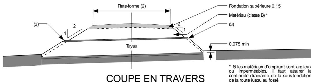
\* Si les matériaux d'emprunt sont argileux ou imperméables, il faut assurer la continuité drainante de la sous-fondation de la route jusqu'au fossé.
