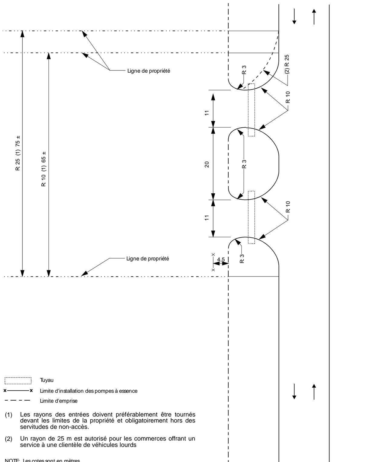
Figure 16.6.4<sup>e</sup> : Entrée commerciale à grande surface (une entrée et une sortie)
