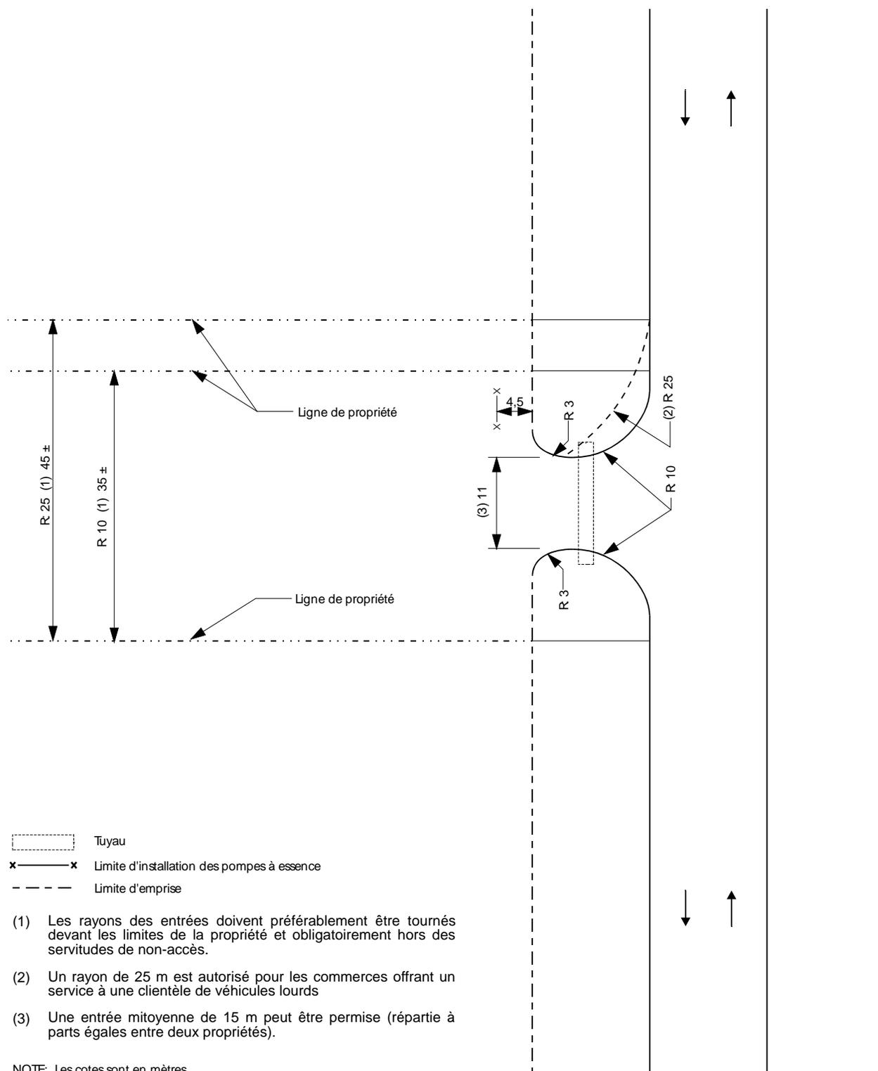
**Figure 16.6.4d : Entrée commerciale hors intersection
