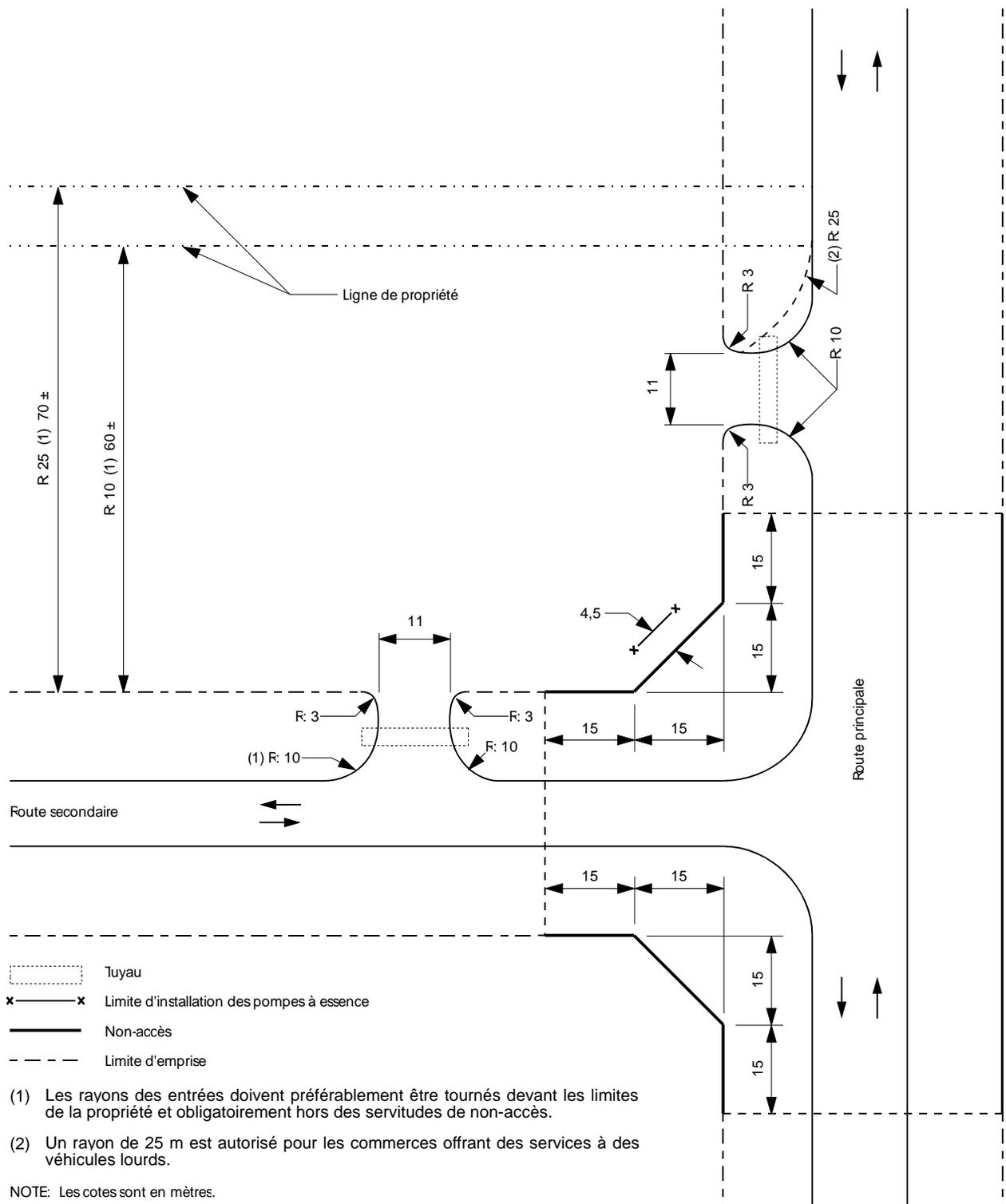
Figure 16.6.4b : Entrée commerciale à une intersection
