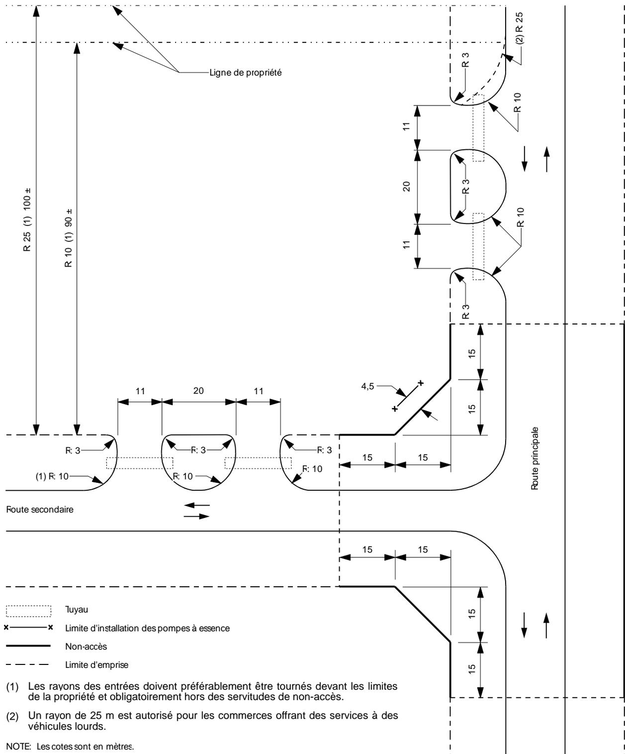
Figure 16.6.4c : Entrée simple commerciale hors intersection
